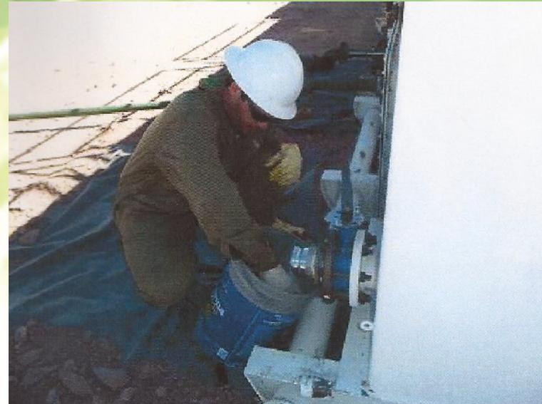
**Toma de muestras de agua de retorno a la salida del separador y el tanque de almacenamiento de agua de retorno.**
